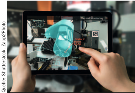
→ Bild 2: Condition Monitoring eines Elektromotors auf dem Tablet
